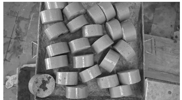
Hình 4. Mẫu bê tông phục vụ thí nghiệm RCPT và hấp thụ nước mao dẫn
