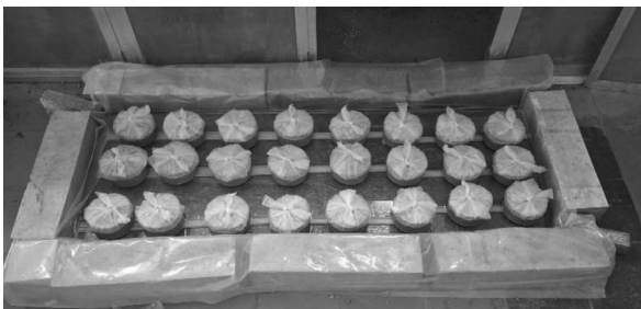
Hình 5. Xác định độ hấp thụ nước mao dẫn theo ASTM C1585
