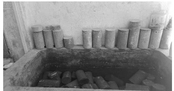
Hình 3. Bảo dưỡng mẫu bê tông trong nước trước khi tiến hành thí nghiệm.
